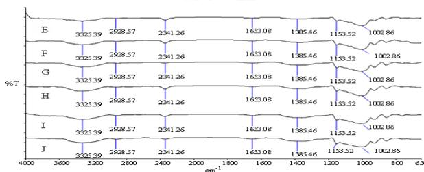
**Figure 9.** FTIR spectra for starch films (control and UV-treated) E) SM 75:25 0h, F) SM 75:25 2h, G) SM 50:50 0h, H) SM 50:50 2h, I) SM 25:75 0h and J) SM 25:75 2h
